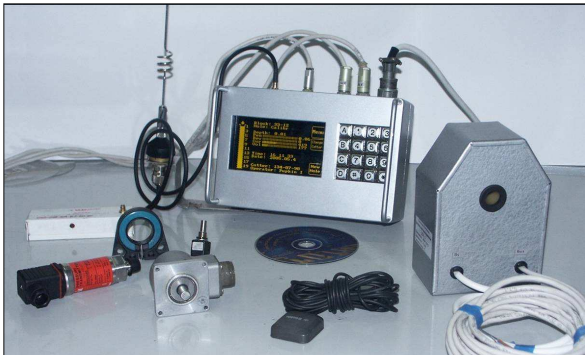
Рис. 2. Многофункциональное устройство для измерения и регистрации различных параметров процесса бурения взрывных скважин на карьерах - контроллер бурового станка «Кобус»
