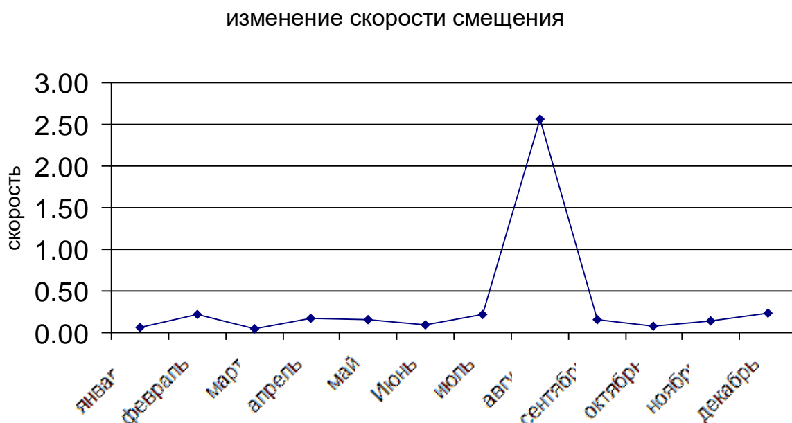
Рис.2. Графическое представление изменения скорости смещения (мм/час) репера в точке наблюдения с номером 3962-78 (северо-западный борт)
