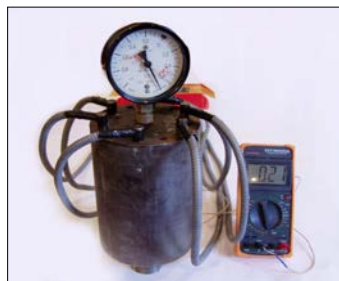
Рис. 2. Действующая модель генератора взрывов зарядов из воды
