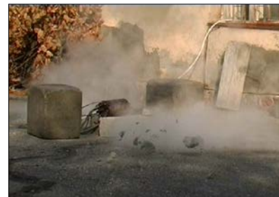
Рис. 4. Генератор взрывов в процессе разрушения блока породы
