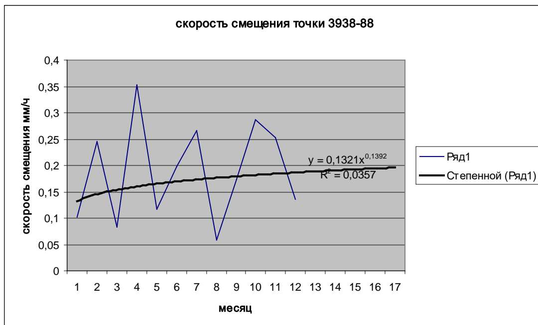
Рис.7. Для прогноза используется степенная функция. Величина достоверности аппроксимации R^2 мала и равна 0,0357.
