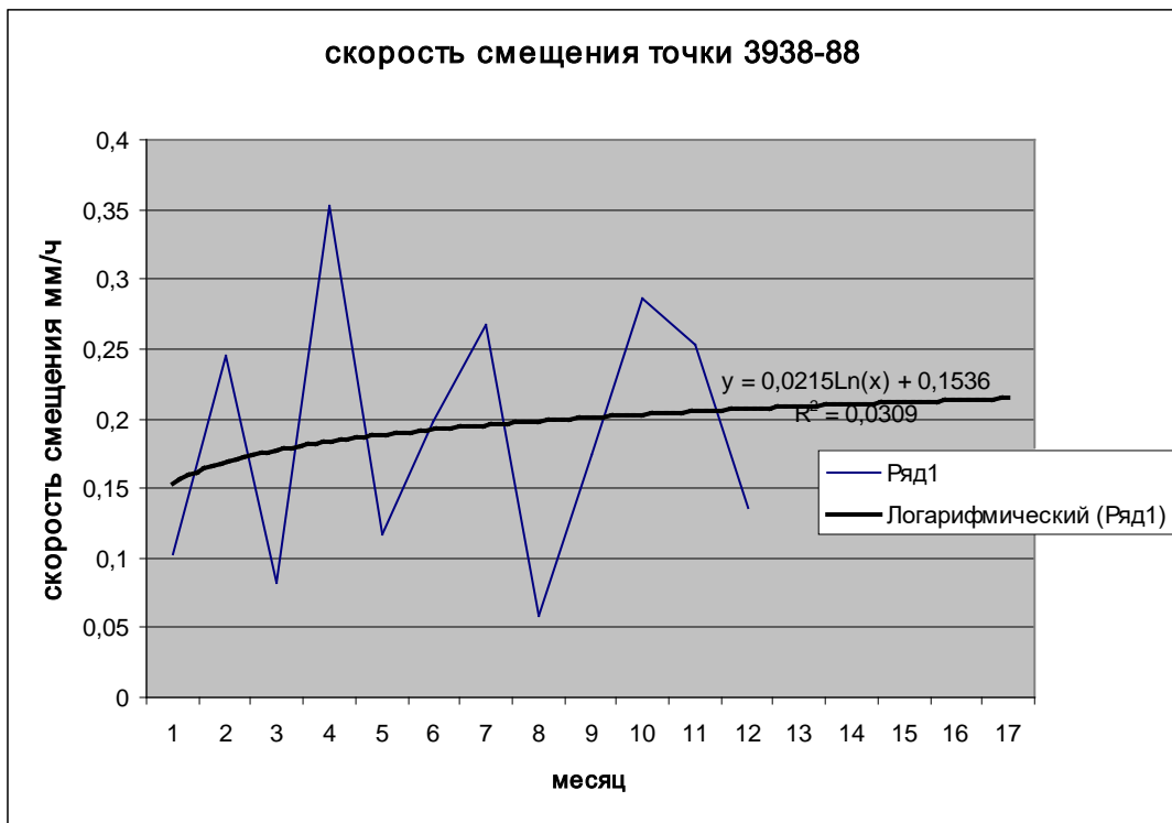
Рис.5. Для прогноза используется логарифмическая функция. Величина достоверности аппроксимации R^2 мала и равна 0,0309.
