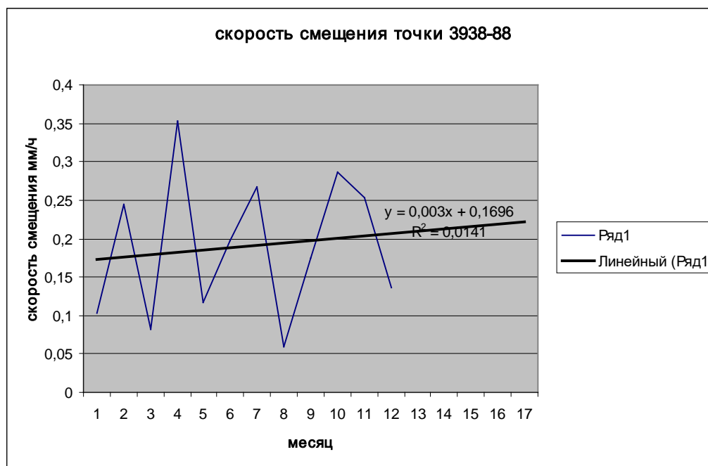
Рис.4. Для прогноза используется линейная функция. Величина достоверности аппроксимации R^2 мала и равна 0,0141.
