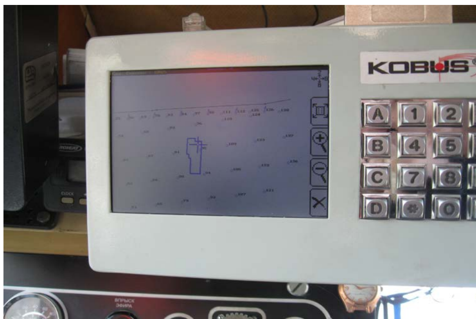
Рисунок №5 Экран прибора Кобус с текущим положением бурового станка и паспортом на бурение блока.
