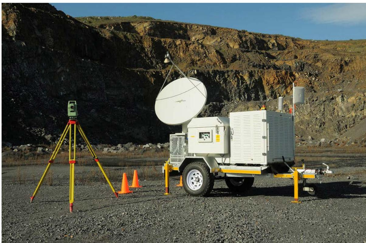
Рисунок 1: Система радиолокационная для слежения и геодезической съемки (СРСГС)
